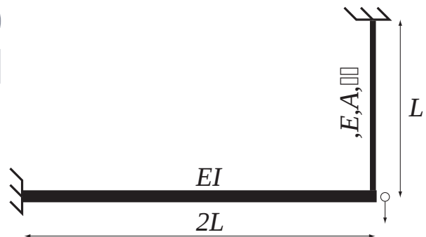
figur 2 Vertikal stång vilande på en konsol och utsatt för en temperaturhöjning \Delta T .
